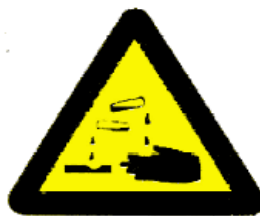
Výstraha, riziko koroze nebo poleptání
