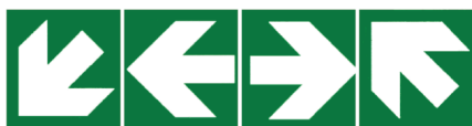
Směrovka (dolů, vlevo, vpravo, nahoru) k zařízení pro přivolání první pomoci (lze použít s dodatkovou tabulkou)
